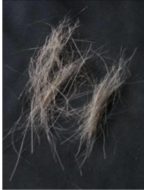
links: bovenzijde stucplafond met leemruggen rechts: kalverharen die in de mortel worden verwerkt
